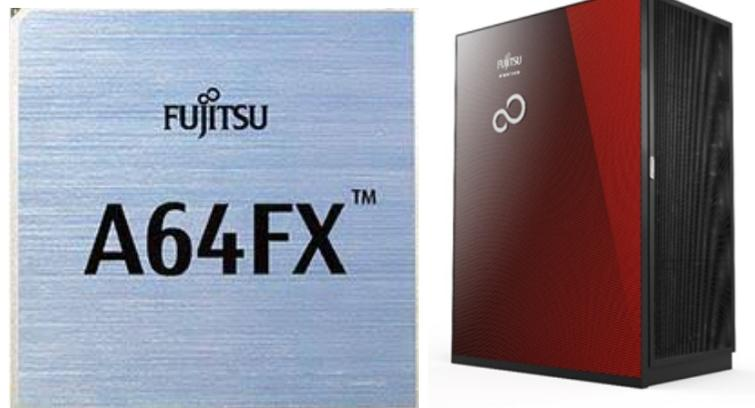
(a) Procesador A64FX basado en arquitectura ARM (b) Supercomputador Fujitsu PRIMEHPC FX1000 utiliza el procesador A64FX basado en ARM
