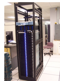
Figura 6. HPC de la Universidad de Minesotta, usado por la escuela de Ciencia, Ingeniería y Tecnología. Cuenta con un nodo maestro y 34 esclavos, cada uno aporta 8GB RAM y 2 dual-core AMD Opteron chips. Todos los nodos corren en Linux.
