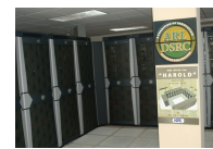
Figura 5. HPC de la Universidad de Minesotta, usado por la escuela de Ciencia, Ingeniería y Tecnología. Cuenta con un nodo maestro y 34 esclavos, cada uno aporta 8GB RAM y 2 dual-core AMD Opteron chips. Todos los nodos corren en Linux.
