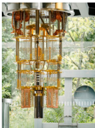
Figura 3: Un criostato de IBM cableado para un prototipo de sistema de 50 qubit (PRNewsfoto / IBM)
