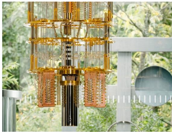
Figura 3: Computador Cuántico IBM Q y su sistema de enfriamiento por fases, este enfriamiento se hace con superconductores y en cada capa baja más la temperatura hasta llegar a la aproximación del cero absoluto. El procesador cuántico se encuentra en la parte inferior, su sistema de enfriamiento se encuentra superior a este.
