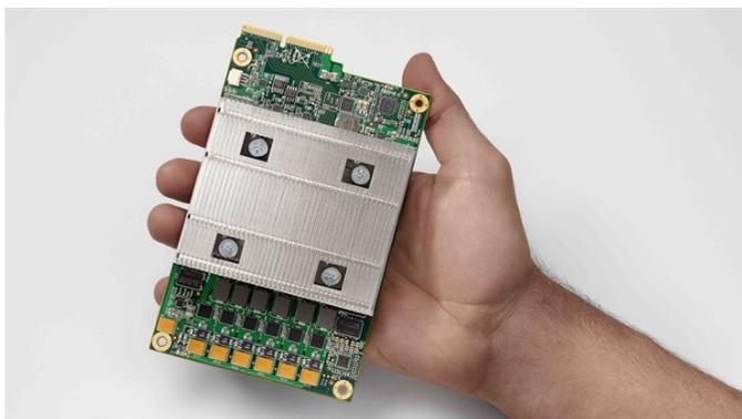
Figura 1. Chip TPU creado por Google para inteligencia artificial
