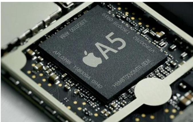
Figura 11. Microprocesador Apple A5 con ARM-Cortex A9
